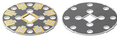
Wirebonding-Substrat für den QPU-Chip
